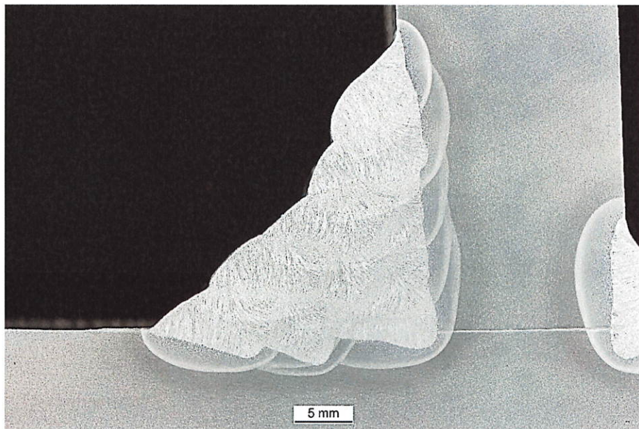
32-6 Makroaufnahme der Schweißung macrograph of weld macrographie de la soudure
